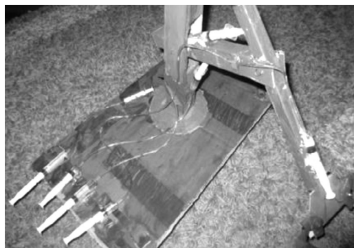
Рис.2. Функциональный макет гидравлического крана
